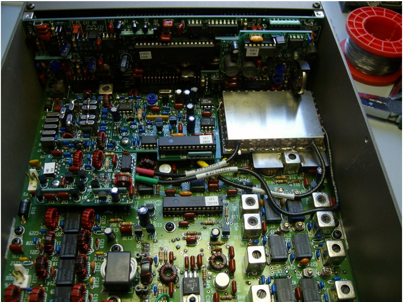
K2 – Posizionamento dell'H-Mode Mixer all'interno dell'apparato
