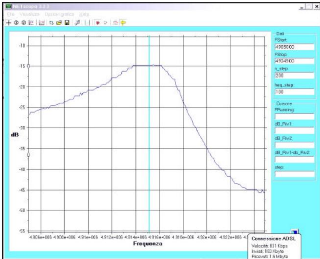
Filtro con condensatore centrale =15 pF (BW=2 KHz)
